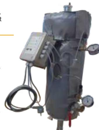
Le **coffret** équipé de 2 capteurs de pression 4-20mA 0-10 bar, contrôle l'encrassement du filtre par mesure du delta P. Une alerte par Led visuelle signale le seuil d'encrassement atteint. A seuil d'encrassement +10 %, le filtre est colmaté ; le coffret commande l'arrêt de la pompe pour lui éviter un fonctionnement sans débit.
